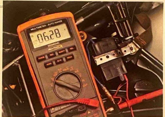
DT1のバッテリーは6Vなので、6.3V前後が規定電圧となる(12V車の場合は12.5V前後)、これに足りなければ充電し、それでも回復しない場合はバッテリーを交換する必要がある
