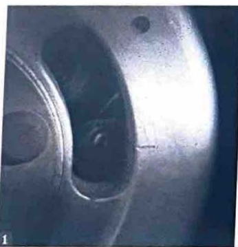
1フライホイールには点火位置を示すFの印がある。タイミングライトを接続し、エンジンを始動させ照らすことで現在の点火タイミングを判断する 2正しい点火タイミングは、Fの位置がクラッチのプッシュロッド用カバーの中心(突起部)付近に来た時になる 3タイミングが異なる場合はプレートの位置を調整し、合わせておくこと。ギャップの調整は、写真のビスをゆるめて合わせることになる
