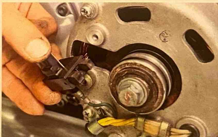
ステータコイルの内側にあるロータ(フィールドコイル)へは、歯に接しているブラシから電気が流され(非接触式のブラシレスもあり)、ブラシの配線はレギュレータへつながっている
