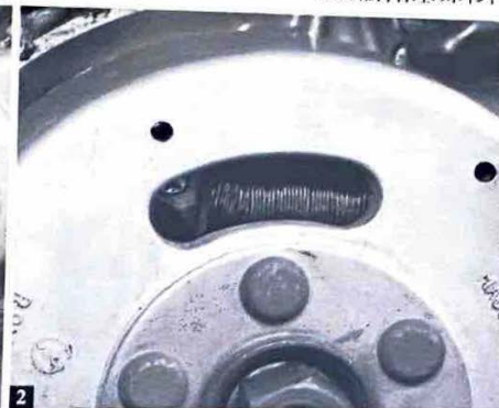
1フライホイールの磁力が落ちてると発電量が落ちる。ユニオンクラブでは磁力を付加する巻線作業も請け負っているとのこと 2コイルは細い線を巻いて作るだけに断線することも。巻き直して直すことになるが、これもユニオンクラブで対応可能だ
