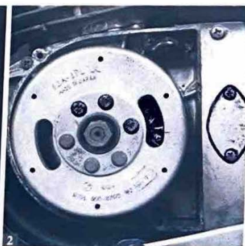
1フライホイールには点火位置を示すFの印がある。タイミングライトを接続し、エンジンを始動させ照らすことで現在の点火タイミングを判断する 2正しい点火タイミングは、Fの位置がクラッチのプッシュロッド用カバーの中心(突起部)付近に来た時になる 3タイミングが異なる場合はプレートの位置を調整し、合わせておくこと。ギャップの調整は、写真のビスをゆるめて合わせることになる
