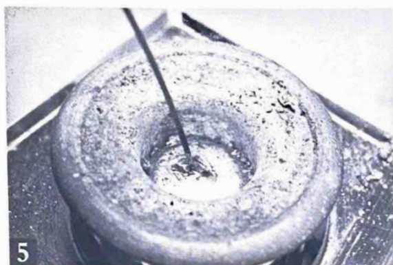
5 先ほどの状態で数秒待ったら、タイコが隠れるまでハンダに浸け込む。根本のワイヤーに、毛細管現象でハンダが吸い上げられていくのが分かれば、ハンダ付けは終了だ
