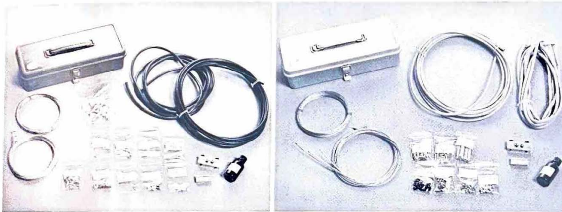
左はスロットルケーブル用補修キット（16,170～17,220円）で、右側がクラッチケーブル用補修キット（18,060～19,320円）。それぞれアウターの色違い、外径違いが揃う。ある部品を使い切ったら買い直さなければいけない、という訳ではなく、キットに含まれている部品の単品販売も行なっているので安心だ
