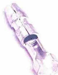
心線用と被覆用、2カ所の圧着部を持つ端子が、オープンバレル端子。圧着部は開いている。バイクやクルマでは使用頻度が高い。
