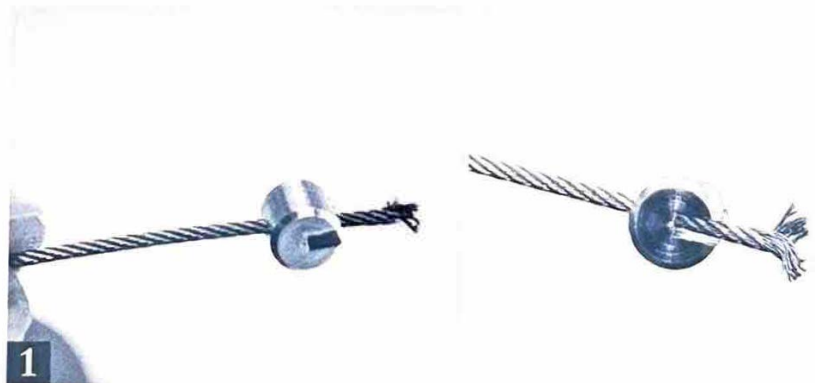
ケーブルの先が解れないよう、適当な長さにカットしたら使用するタイコを通す。その後、ケーブルがよりしっかりハンダ付けされるよう、ケーブルの先端を写真右のようにほぐして広げておこう
