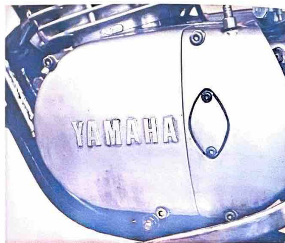
2 DT1の発電機であるフライホイールマグネトー+ステータコイルは、左クランクケースカバーの内側にある。まずはこのカバーを外し、現物を白日の下へ晒そう
