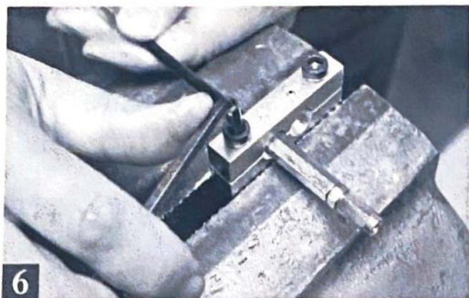
6 アジャスターの丸い部分を工具で挟み込んだら、工具両端のボルトを締め込んでいくことで、アジャスターの棒の部分をかきめて、アウターケーブルと合体させる
