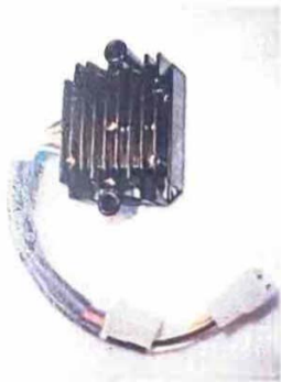
レギュレータ/レクチ 三相交流 ¥18,000 ホンダとヤマハの各モデルに対応する、汎用の三相交流レギュレータ/レクチファイヤ。充電不良や過充電の対策に使用できる
