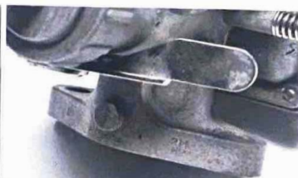
2 1キットのVM30SHキャブレター。外観はノーマルのVM26SHとほぼ同じだが、メインボアが4mm大きい。2外観上の識別ポイントが、吸気筒の部分にある「M」の刻印である
