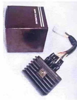
別体式レクチファイヤ 三相交流 ホンダ用 ¥10,000 ホンダの車両に適合する、三相交流発電用の別体式レクチファイヤ。CB750やCB500、CB400、CB350などにはボルトオンで使用可能
