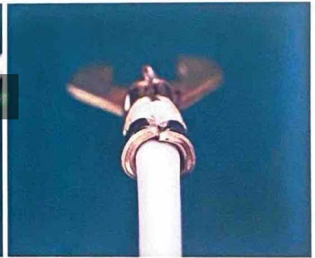
9 すべての工程が終わり、正しく圧着できたオープンバレル端子。ここで注目してほしいのは被覆部の圧着具合。軽く包み込んでいる程度だが、この部分の役割は端子の首振り防止で、端子の抜け止めではないので、これで充分なのだ
