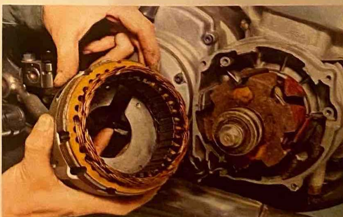
ステータコイルを取り外した状態。クラシクの歯に固定されたロータは、その内側にフィールドコイルが巻かれ、ブラシから電気が流れた時にのみ発電を発生して電磁石となる
