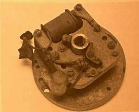
レース用のコイル。火花プラグの発電機能は不要なので、点火に使う分だけの、最低限の発電ができるようコイルが設計されている
