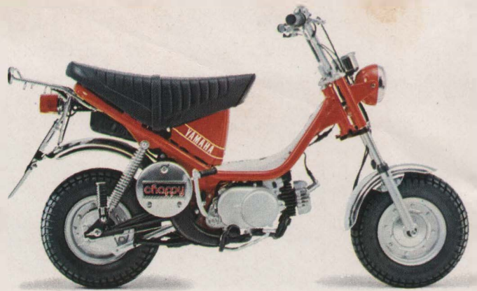
LB2 M Chappy. 1-Zyl.-2-Takt-Motor, 49 ccm, 2,84 PS (2,1 kW) bei 5.000 U/min, 40 km/h, 2-Gang-Automatik. Führerscheinklasse 5. Rot, Blau. DM 1.450,-*
