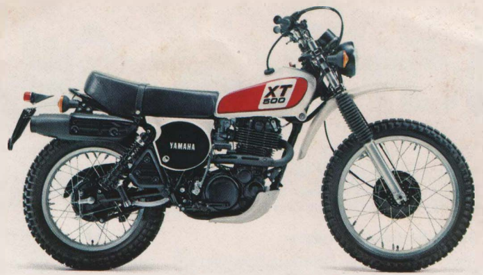
XT500. 1-Zyl.-4-Takt-OHC-Motor, 499 ccm, 27 PS (19,9 kW) bei 5.900 U/min, 135 km/h, 5 Gänge. Weiß. DM 4.700,-*
