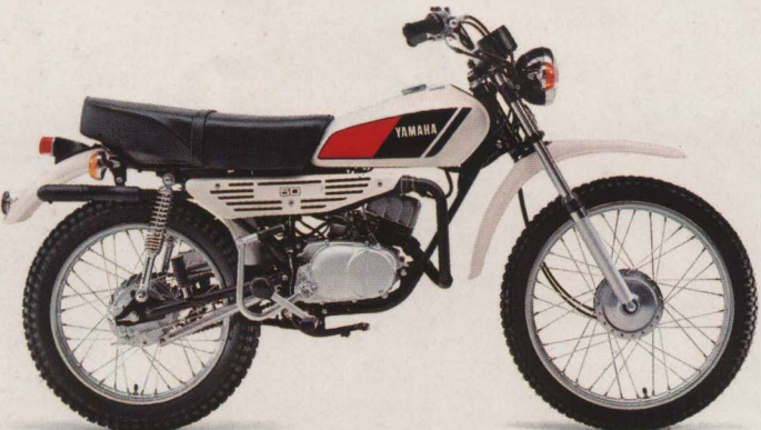
NEU DT50 M. 1-Zyl.-2-Takt-Motor, 49 ccm, 2,89 PS (2,1 kW) bei 5.100 U/min, 40 km/h, 4 Gänge. Führerscheinklasse 5. Weiß, Rot. DM 1.800,-*
