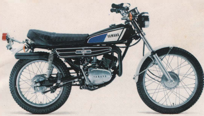
DT125E. 1-Zyl.-2-Takt-Motor, 123 ccm, 10 PS (7,4 kW) bei 6.800 U/min, E-Starter, 100 km/h, 5 Gänge. Blau. DM 2.780,-*
