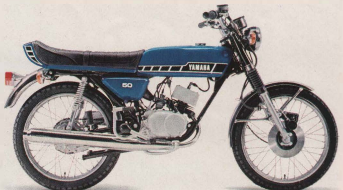
RD50. 1-Zyl.-2-Takt-Motor, 49 ccm, 6,25 PS (4,6 kW) bei 8.300 U/min, 90 km/h, 5 Gänge, Scheibenbremse vorn. Führerscheinklasse 4. Blau. DM 2.300,-*
