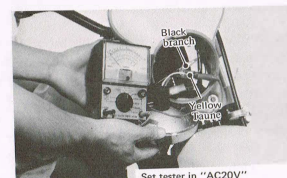
Set tester in "AC20V" Mettre l'ohmmètre sur la position
