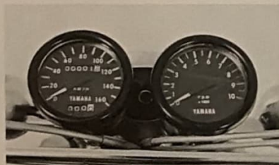
見やすいセバレットタイプのタコメーター、スピードメーター
