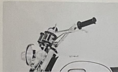
苛酷なトレールライディングにも タフにこたえるブリッジ付ハンドル
