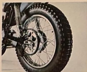
タイヤはユニバーサルトライアルパターン、高速走行も可能
