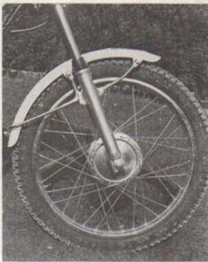
Les fourches sont identiques. Ne diffère que la position du garde-boue avant. Sur la D.T.E. il est à ras la roue, ce qui évite bien des projections mais entraîne un risque de « bourrage » en tout-terrain. Le freinage est très puissant. C'est un facteur de sécurité, en ville, comme en tout-terrain.
